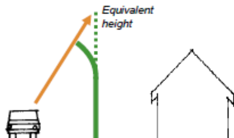
Slika 8. Konzolna zaštitna barijera nagnuta prema putu može povećati efikasnosti zaštite od buke
