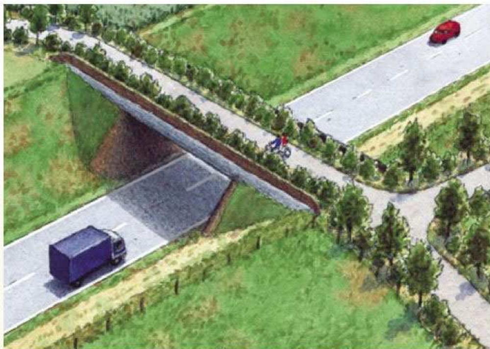
Slika 20. Zeleni vijadukt (prelaz) (Limpens et al. 2005).
