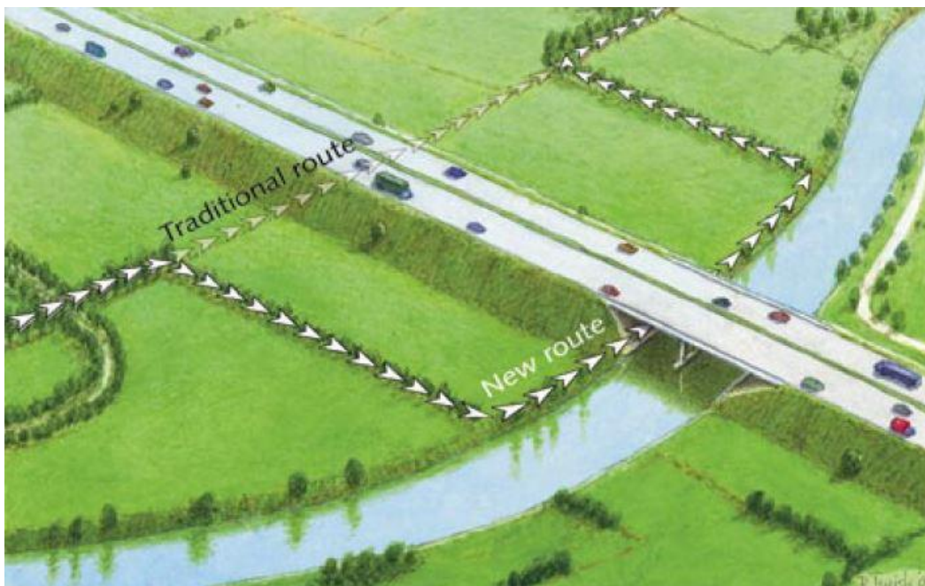
Slika 3a. Vodeni podvožnjaci (Limpens et al. 2005.)
